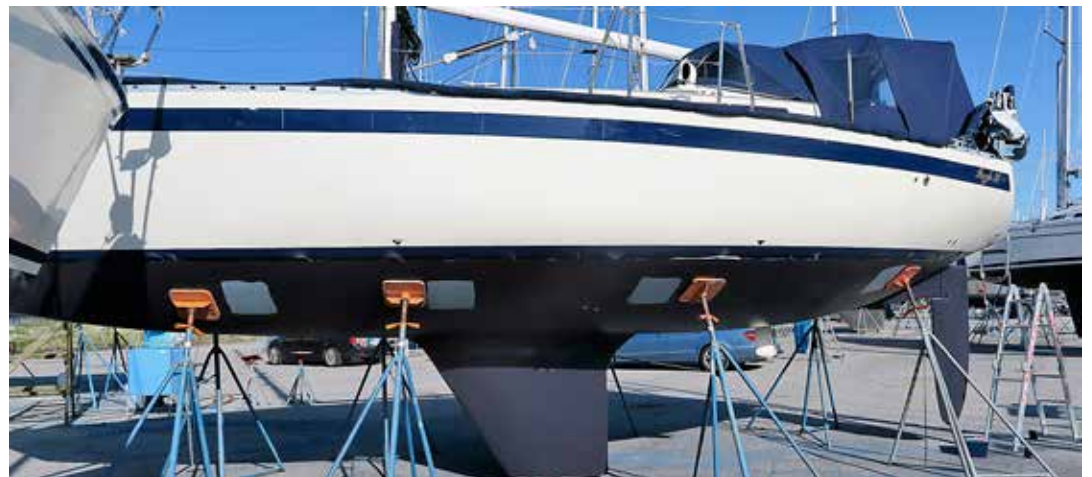
Blästrad och färdigmålad med grund- och bottenfärg, så när som på stöttornas tidigare täckta ytor.
